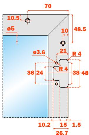
Foratura con squadretta di fissaggio **DEL6BSFV02**
