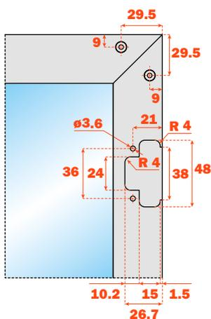
Foratura con squadretta di fissaggio **DQZ3HS5V04**
