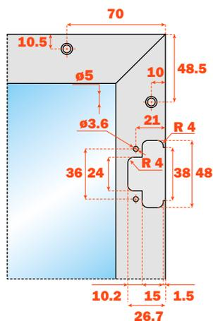
Foratura con squadretta di fissaggio **DEL6BSFV02**
