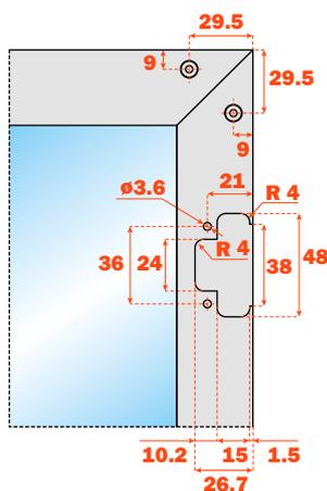
Foratura con squadretta di fissaggio **DQZ3HS5V04**
