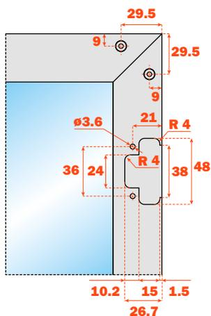
Foratura con squadretta di fissaggio **DQZ3HS5V04**
