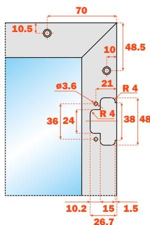
Foratura con squadretta di fissaggio **DEL6BSFV02**
