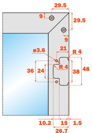
Foratura con squadretta di fissaggio **DQZ3HS5V04**
